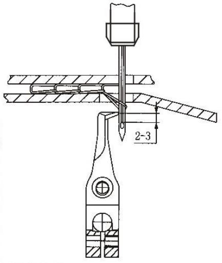
Во время опускания иглы в самую низкую позицию расстояние между кончиком челнока и верхним краем игольного отверстия должно быть в пределах 3 - 3,5 мм. В противном случае ослабьте зажим болта A для регулировки.
