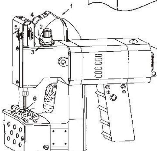
Процесс заправки нити в соответствии с порядковыми числами. Отражающими последовательность шагов следуя стрелкам. Смажьте каждое рабочее звено машинки 1 раз.
